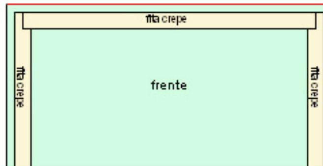
pontos de aplicação de uma camada fina de silicone, apenas nos topos dos vidros, imediatamente antes da montagem.
